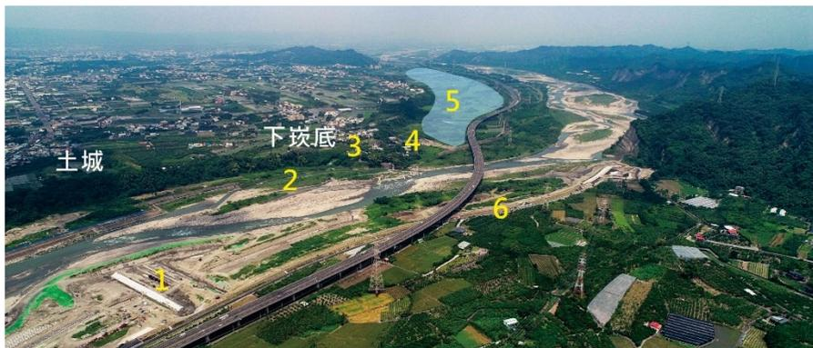
照片 5-1 鳥嘴潭人工湖施工區域現況。1 為攔河堰、2 為沉沙池預定地、3 為引水隧道、4 為分水工預定地、5 為人工湖範圍、6 為烏溪平林二號堤防。照片中之地形分布請參閱照片 4-6 所示。(2019 年 8 月 7 日攝)
